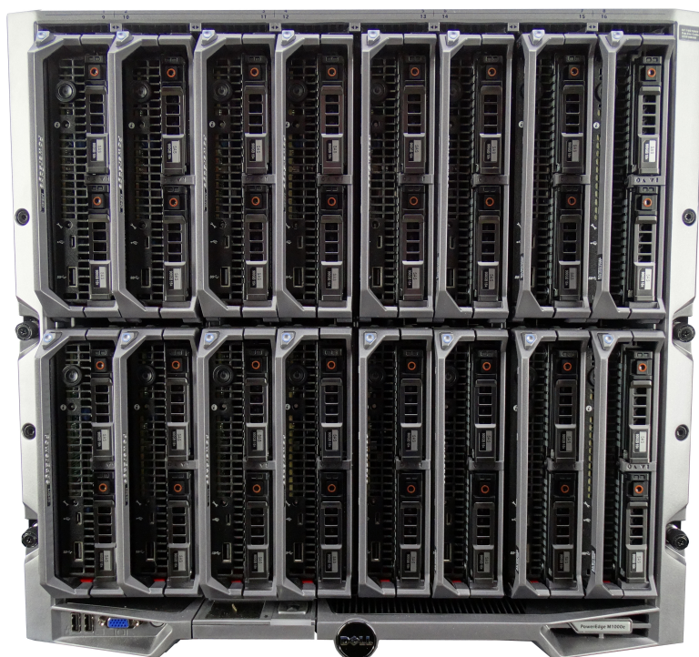
Obrázek 1.8: Dell PowerEdge M1000e skříň s 16x M640 blade servery (převzato z [33])
