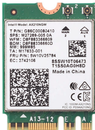
Obrázek 2.1: Intel Wi-Fi 6E AX210 (převzato z [54])
