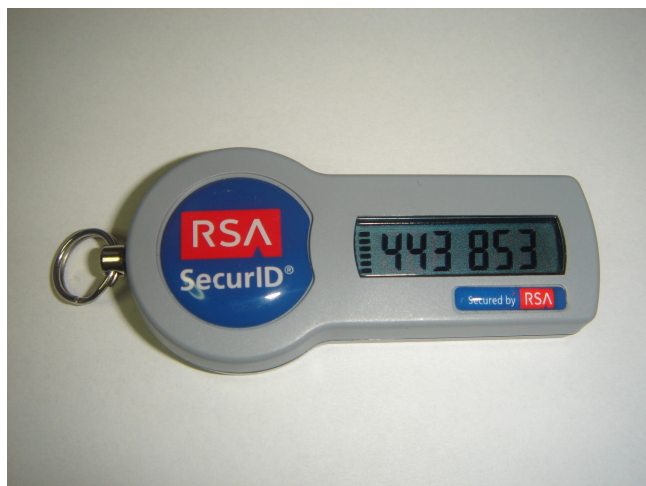
Obrázek 3.7: RSA SecurID SID800 token bez USB konektoru (převzato z [25])
