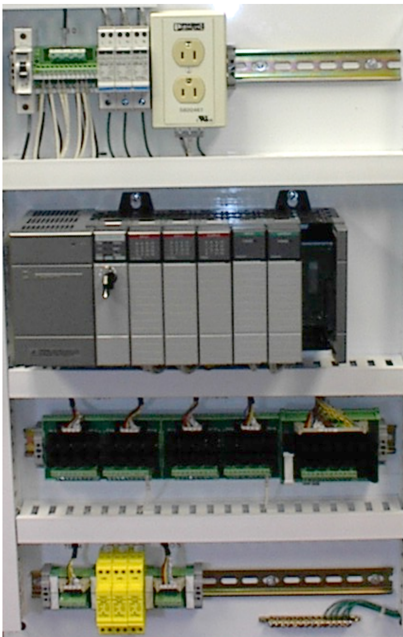
Obrázek 1.2: Příklad PLC a řídicího systému (převzato z [10])
