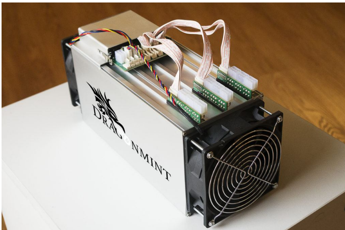
Obrázek 3.6: DragonMint 16T jako příklad specializovaného hardware pro krypto těžbu (převzato z [86])
