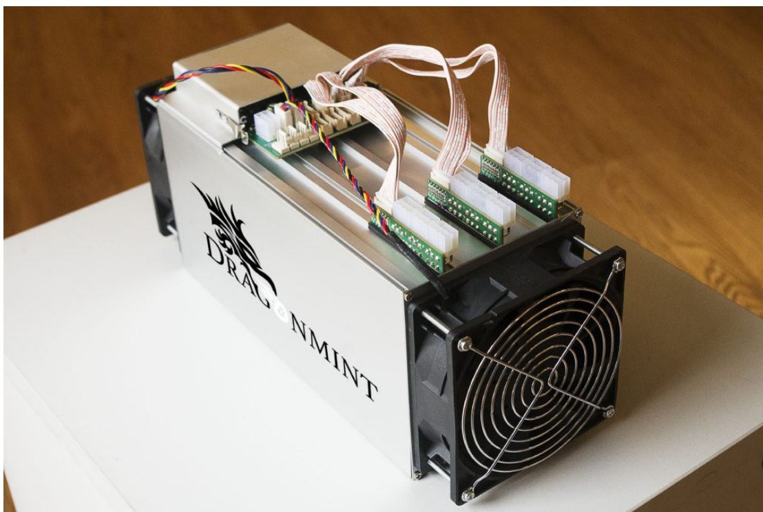
Obrázek 3.5: DragonMint 16T jako příklad specializovaného hardware pro krypto těžbu (převzato z [78])
