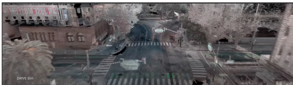
Obrázek 1.7: Point cloud vytvořený analýzou zachyceného obrazu (převzato z [68])
