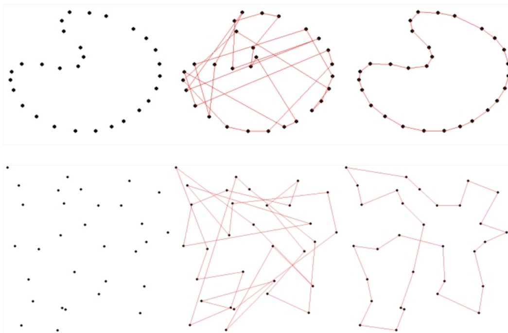
Obrázek 9.2: Možné řešení problému obchodního cestujícího (převzato z [8])
