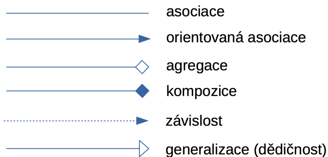
Obrázek 5.3: Typy asociací podporované UML diagramy
